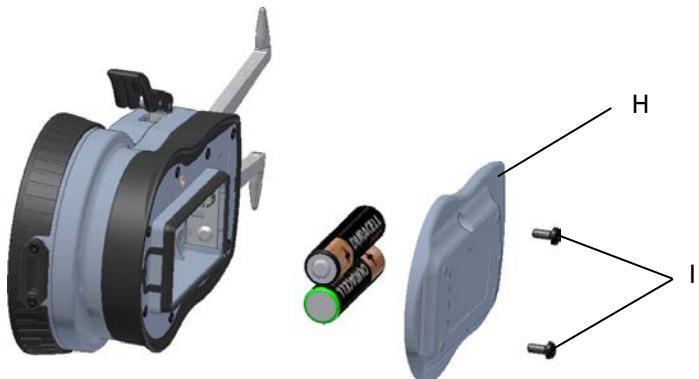
Despues de cambiar las pilas atornillen nuevamente la tapadera de las baterias (H) con los dos tornillos (I) a la carcasa.
