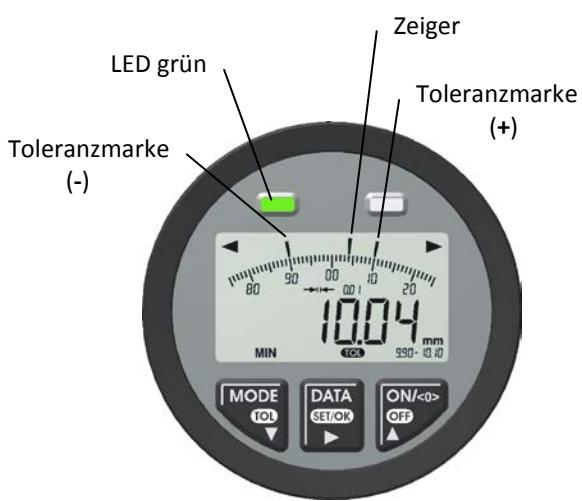
Die LED erlischt 5 Sekunden nach Finden des Messwertes und schaltet nach Finden eines neuen Messwertes wieder ein.
