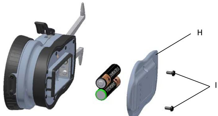
Nach dem Wechsel der Batterien schrauben Sie den Batteriedeckel (H) mit den beiden Schrauben (I) wieder am Gehäuse fest.
