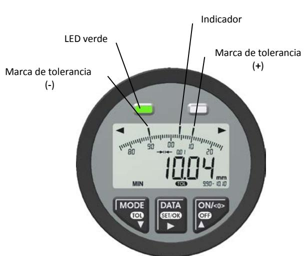
La LED se apaga 5 segundos después de encontrar el valor de medición y se enciende posteriormente al encontrar un valor de nueva medición.
