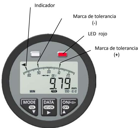
Resultado de medición fuera de la tolerancia:
